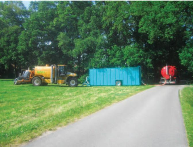
*Gülle-Transfer: rechts der anliefernde LKW, in der Mitte die Zwischenlagerung im Container und links das selbstfahrende Güllefass zur Ausbringung*
